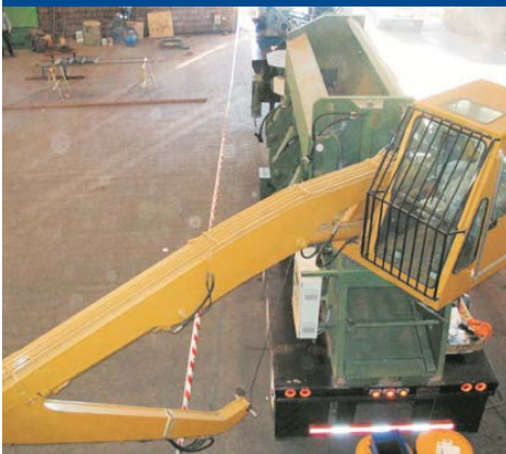
Esta es una de las dos nuevas prensas móviles con que cuenta Gerdau AZA, puede procesar 1.500 toneladas de chatarra al mes.
