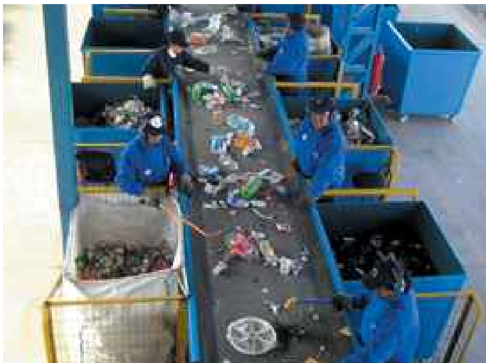
Este es parte del proceso donde se clasifican los materiales reciclables, entre ellos la chatarra de fierro.
